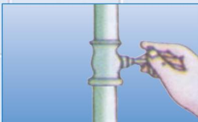
2 - Abra el registro de la tubería de la descarga en la salida de la bomba antes de montar la bomba para que la salida de aire, eventualmente, pueda estar en la tubería. Instale el filtro en la conexión de latón en la entrada de la bomba antes de la instalación.
