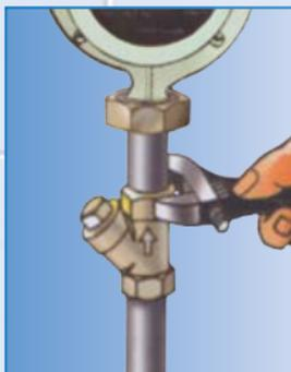
2 - Instale el filtro que ya viene incluido como accesorio en la BPR-12 o, si prefiere, instale un filtro de línea como muestra la figura.
