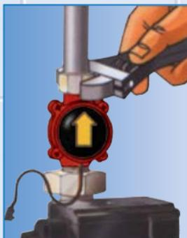
3 - Instale el sensor de flujo en la salida de la bomba.
